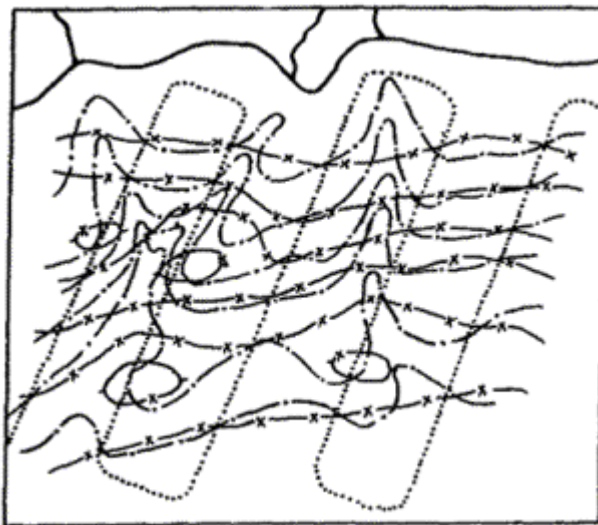
Рис. 7.4. Искажение изображения подводных долин при их обследовании продольными галсами:
